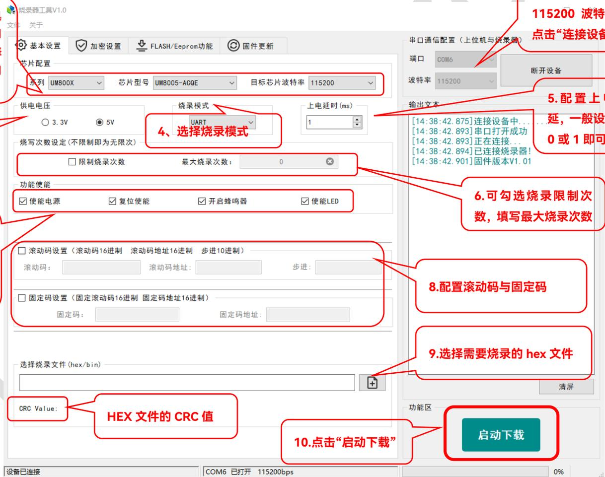
图 3-1: 烧录器上位机界面操作示意图
