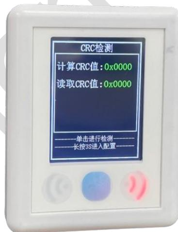
等待烧录器上电复位后，正确连接烧录器和目标芯片的 SWD 接口，通过单击【烧录触发】按键，即可读取目标芯片的 CRC 值。如果要退出，可以通过长按按键重新退出 CRC 检测模式，也可以直接通过上位进行一次固件预存，即可回到正常的烧录界面。
